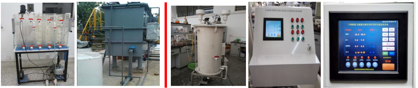
图13 A-OBSB 一体化设备中试样机(a)和工程现场(b) 图14 生物淋滤-铝碳微电解反应器中试样机(a)、连机控制器(b)和远程控制器(ca)
